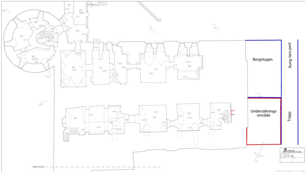
Figur 49. Sprängskiss som visar den nuvarande rumsfördelningen i Tvärslottets nedre källarplan. Ungefärligt läge för undersökningsområdet är markerat med rött. I det västra källarrummet är även det ungefärliga läget för den igensatta portalen markerat i rött. Det är i denna igensättning som borrhingsförsök gjordes. Planunderlag, Statens Fastighetsverk.
