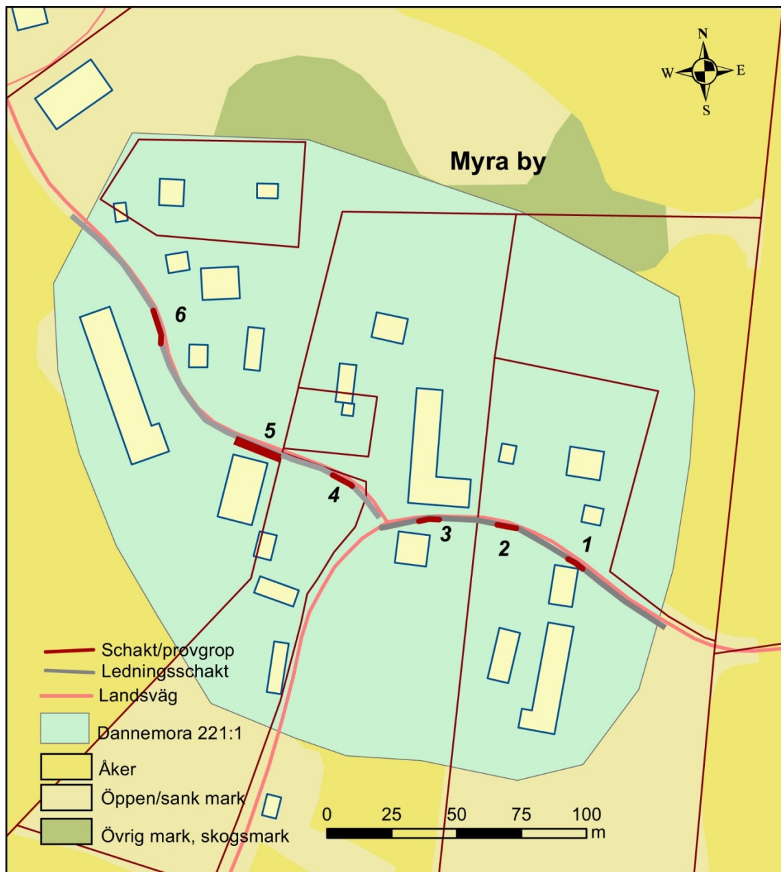
Figur 7. Översikt över byn Myra och utbredningen av dess bytomt Dannemora 221:1. Kabelschaktet grävdes längs byvägens södra kant i öst-västlig riktning (grå markering). De röda markeringarna visar läget för de sex provgroparna och det schakt som togs upp i anslutning till en av dem (nr 5). Skala 1:2000.
