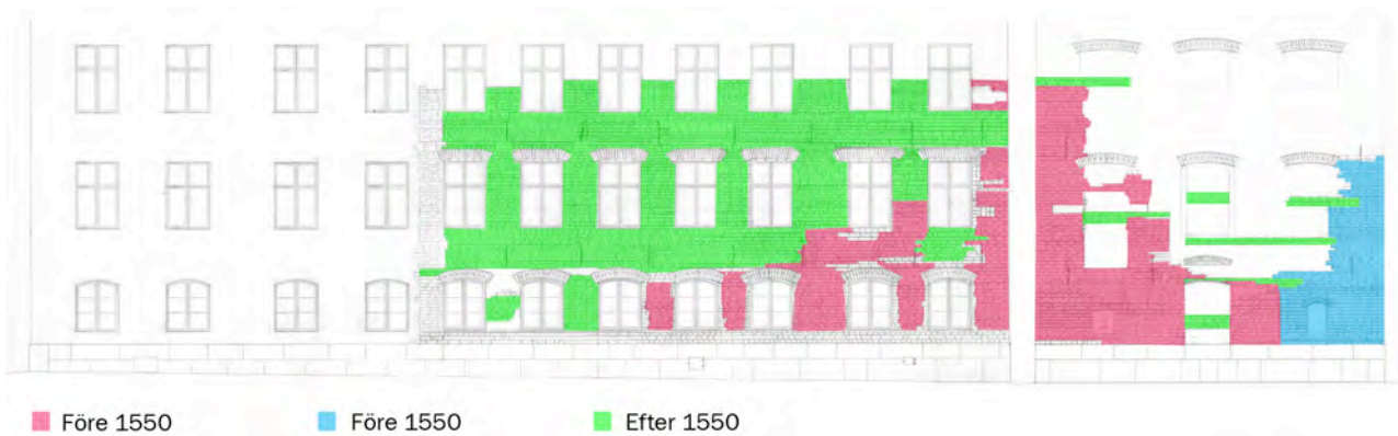
Figur 18. Tolkningsskiss av urskiljbara byggnadsskedena i Dekanhusets murverk. Efter murverksdokumentationen av den östra fasaden och norra gaveln från 1936-37. Skissen är något förenklad. Illustration: Joakim Kjellberg, Upplandsmuseet.
