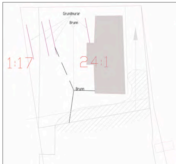
Figur 5. En sammanställning av resultaten av markradarundersökningen från Bjerking's rapport PM. Det skrafferade området på planen t.v. visar området med omrörda jordmassor och möjligen äldre gravar, de lila strecken visar de grundmurar som påträffades och sammanfaller med de som påträffades 1911. T.h. den redovisade markradarprofilen ur samma rapport.
