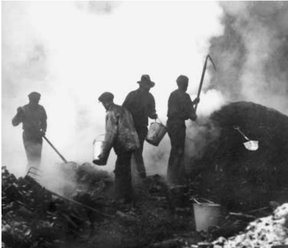
Figur 40. Varmrivning i Gårdskär, Älvkarleby i slutet av 1930-talet. (Upplandsmuseet bildarkiv Nr RR31, fotograf, A. Hallenberg).
