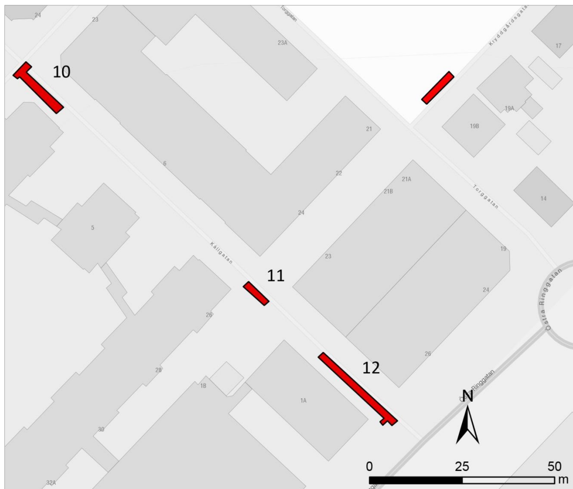
Figur 13. Schaktplan över schakten i Källgatan/Eriksgratan. Skala 1:1 000.
